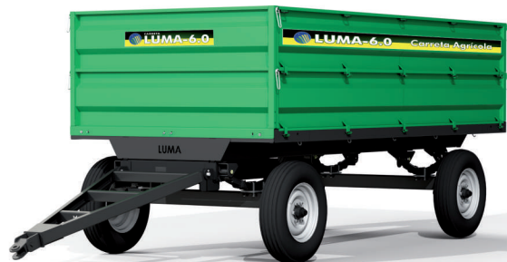
LUMA-6.0 Suspensão por feixe de molas e assoalho e sobreguarda metálicos
