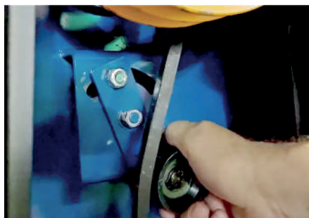
...e girar o suporte com a roldana contra as correias e reapertar as porcas
