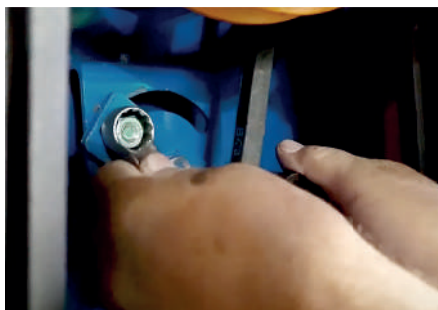
Se precisar ajustar o tensionamento, soltar as duas porcas...
