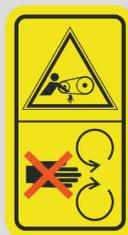
*Não utilize a máquina sem a proteção da correia. O contato com a correia em movimento provoca lesões graves.*
