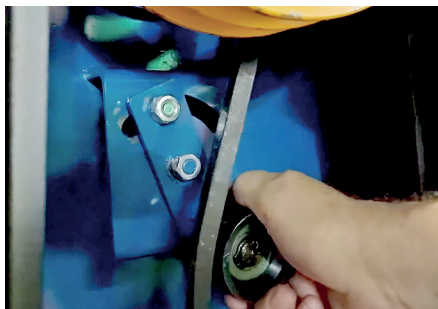
...y gire el soporte con la polea contra las correas y vuelva a apretar las tuercas
