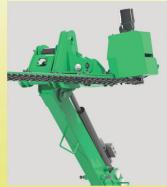
Unidade de corte acionada por motor hidráulico
