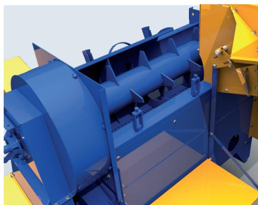
Potente rotor processa o cereal sem danificar os grãos.
