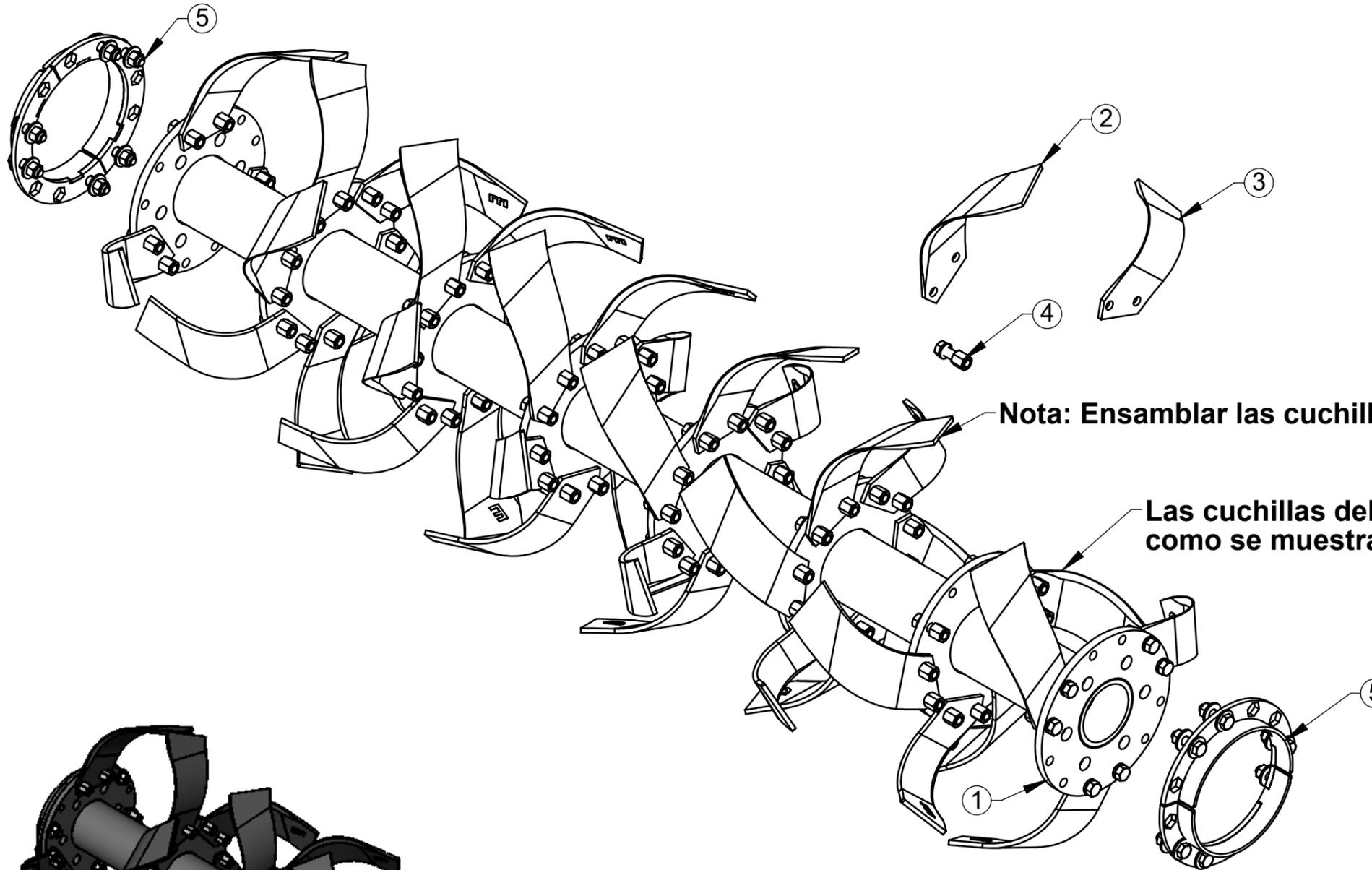
**Nota: Ensamblar las cuchillas formando una hélice.**
