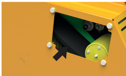
Retirar a tampa e lubrificar o rolete do esticador
