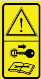
*Desligue o trator antes de iniciar manutenção na máquina. Atenção! O trator deve estar sempre desligado, e a chave retirada da ignição, antes de se efetuar consertos, limpeza, lubrificação ou trabalhos de manutenção na máquina.*
