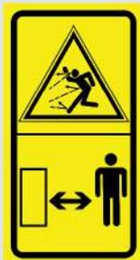
*Mantenha uma distância segura da máquina durante a operação. Há risco de ser atingido por corpos arremessados pelas paletas do rotor varredor.*
