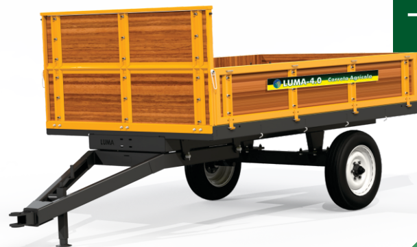
LUMA-4.0 Piso y Guardias en Contrachapado Naval
