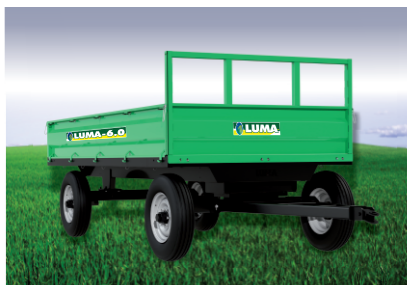
Carreta Luma 6.0 Rodado de dois eixos simples e assoalho e guarda metálicos
