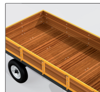
ASSOALHO E GUARDAS EM COMPENSADO NAVAL *(OPCIONAL nos modelos 6.0)
