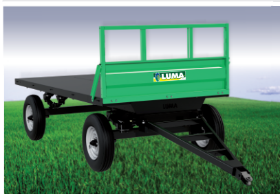
Carreta Luma 6.0 Suspensão por feixe de molas e assoalho liso metálico
