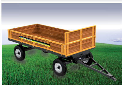
Carreta Luma 6.0 - Suspensão por feixe de molas e assoalho e guarda em Compensado Naval
