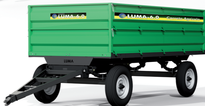
Carreta Luma 6.0 Suspensão por feixe de molas e assoalho e sobreguarda metálicos
