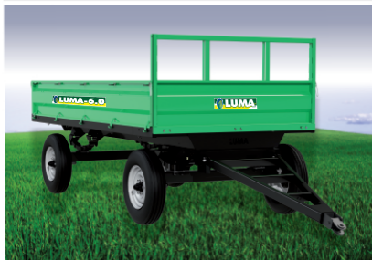
Carreta Luma 6.0 Suspensão por feixe de molas e assoalho e guarda metálicos
