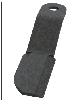
UM LADO DESGASTADO. deve-se inverter as facas de rotor.
