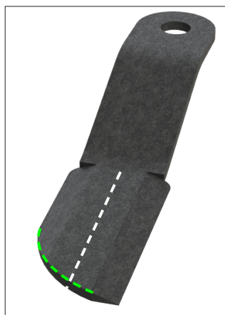
TROCAR A FACA. Quando o desgaste ultrapassa o centro da faca, ela não pode mais ser usada. Troque todas as facas.
